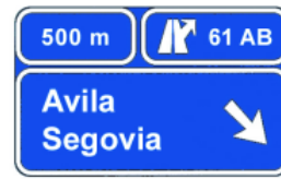
S-242 Preseñalización en autopista o autovía de dos salidas muy próximas hacia cualquier carretera
