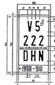
Matrícula ciclomotore temporal empresas (Vehículos matriculados) Fondo rojo. Caracteres blanco mate Banda: Fondo blanco. Caracteres rojo mate adhesivos
