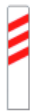
P-9a Proximidad de un paso a nivel, puente móvil o muelle (lado derecho)
